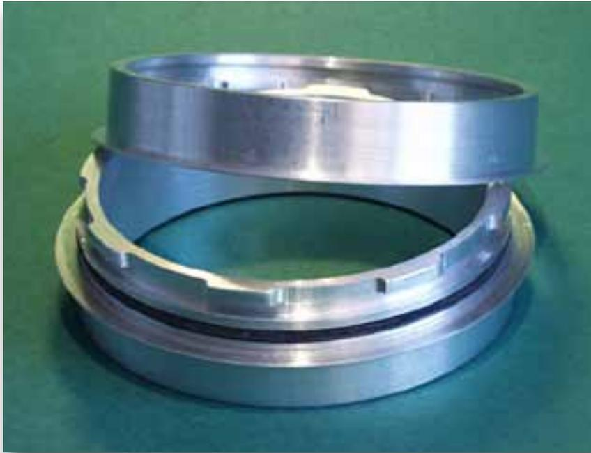
Abdichtung und gutem und schnellen Zugang zu den Einbauten bildet dieser Rumpfverschluss aus Aluminium. Dies gilt insbesondere für Modell-Uboote mit kreisförmigen Rumpfquerschnitten. Die Aggregate werden auf einem Technikgerüst montiert, das in das Rumpfvorderteil eingeschoben wird. Antriebsmotor und Ruderservos werden im kurzen Heckabschnitt fest montiert.
