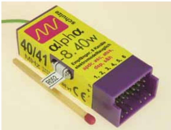
Der Empfänger kann mittels PC und Adapterkabel auf zahlreiche Zusatzfunktionen eingestellt werden. Dazu gehören Failsafepositionen, Servoanschläge, Mischer, Unterspannungskontrolle.
