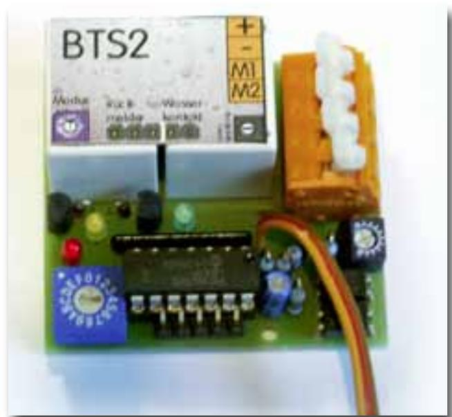
Diese BallastTankSteuerung eignet sich hervorragend zur Ansteuerung eines Kolbentanks oder einer Pumpe oder auch von Magnetventilen eines pneumatischen Tauchsystems.
